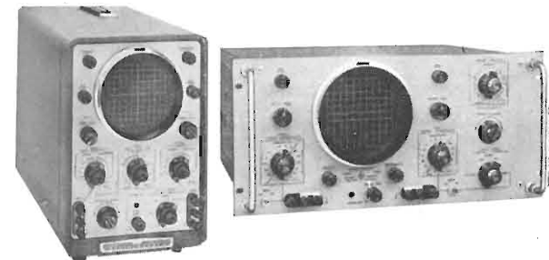
DA C.C. A 300 kHz. MOD. 130A/BR Amplificatore orizzontale e verticale simili — circuiti d'entrata bilanciati sulla cinque portate più sensibili — entrata accoppiata alla c.c. od alla c.a. — portata di sweep da 1 \mu sec/cm. a 12,5 sec/cm. — 21 sweeps tarati — il mod. 130BR comprende un espansore di spazzolamento X5 usabile su tutte le portate, così che lo sweep più rapido è portato a 0,2 \mu sec/cm.
