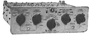
Amplificatore differenziale a doppia traccia mod. 152B Consente un'entrata differenziale e doppie tracce a mezzo di un interruttore selettivo elettronico tra i canali A e B con la frequenza di sweeps alternati o di 100 kHz.
