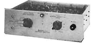
Amplificatore ad alto guadagno mod. 151A Consente un alto guadagno con sensibilità 5 mV./cm. — responso di frequenza da c.c. a 10 MHz. — 12 portate tarate — tempo di salita a larga banda 0,035 \mu sec.
