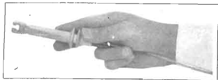
Fig. 1 - Ecco la testina a tenaglia del milliamperometro mod. 428 A. Con un semplice movimento dell'indice della mano è possibile comandarne l'apertura.
